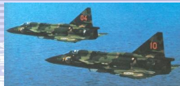
Saab J-37 Viggen: Schubumkehr Entenflügel (Kurzstart/-landung)
