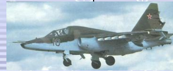
Suchoj Su-25 Jagdbomber Einsatz ab Behelfspisten Hochauftriebshilfen
