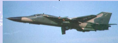
G.D. F-111, Zweistromtriebwerk, Hochauftriebshilfen, var. Geometrie
